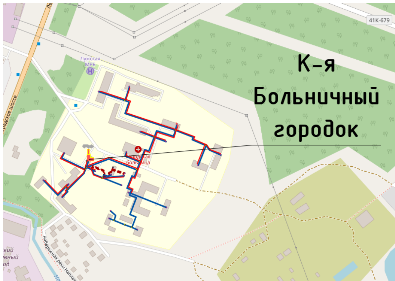
Рисунок 17 Тепловые сети котельной «Больничный городок»
