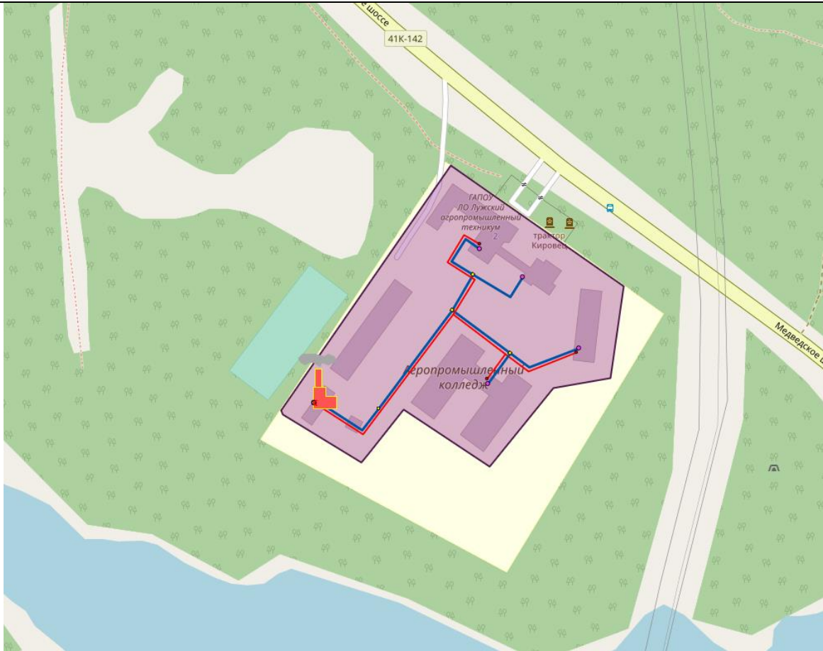
Рисунок 40 Зона действия котельной БМК-2,0 (ООО «Петербургтеплоэнерго»)
