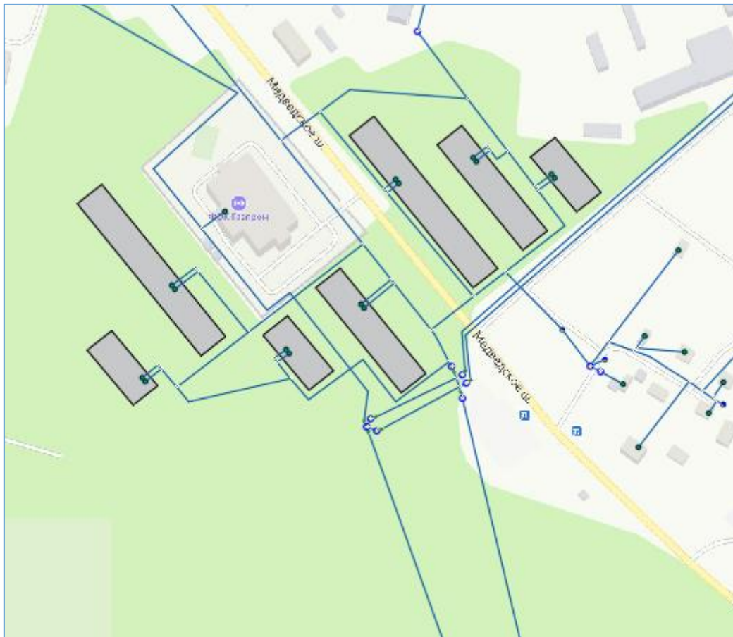
Рисунок 4.9.6. Схема водоснабжения Лужского городского поселения. Подключение к системе новых МКД на Медведском шоссе.
